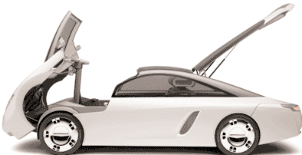
Leichtfüßiger Sportwagen Loremo: Ein geschlossener Stahlrohrrahmen bedingt den Verzicht auf Seitentüren. Eingestiegen wird über Front- und Heckklappe. Im Heck können zwei Kinder gegen die Fahrtrichtung sitzen. Bilder: Loremo
